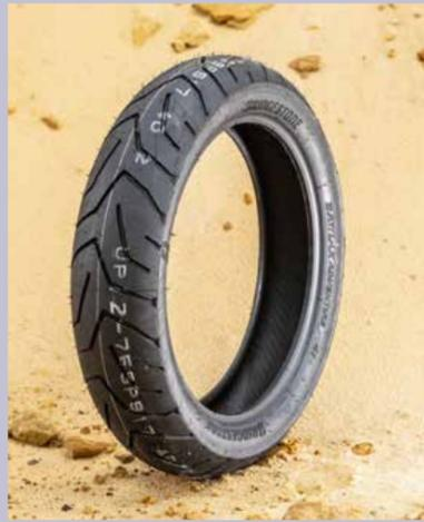
Seine **3LC-Technologie** mit zwei Gummimischungen in drei Laufstreifen soll für Stabilität, Spurtreue und hohe Laufleistung in der Laufflächenmitte sorgen, während die weiche Mischung an den Schultern hohen Grip verspricht. Kombiniert wird das mit „Cap & Base“-Schichten. Die weichere äußere Gummimischung (Cap) sorgt dabei für den Grip, die innere Mischung (Base) ist stabiler und bringt Steifigkeit.
